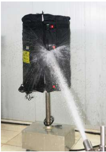
Essais IPx6 des couvertures chauffantes
