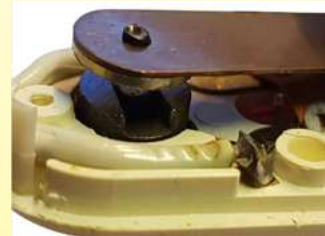
1972 ca Boîtier de réglage de la puissance réalisé par Jidé à Limoges sous la marque Jidéstat. Le plus abouti de tous les systèmes. De très faible dimensions, il est réglable, et incorporé dans la fiche électrique. C'est le seul modèle comportant un contact à rupture brusque par aimant. Il ne sera pas surpassé par les systèmes électromécaniques développés jusqu'à nos jours. (Collection Ultimheat)
