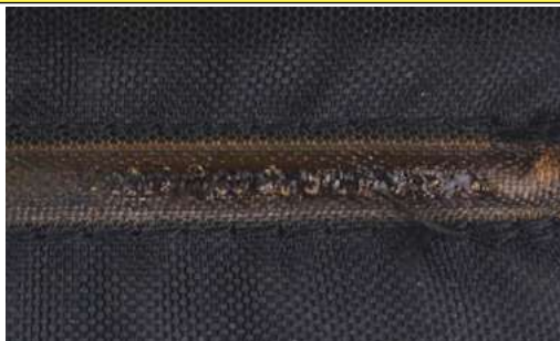
1h à 235°C sur le câble chauffant : Le PA66 commence à fondre
