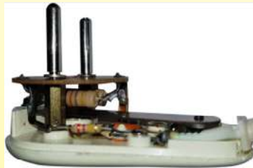
1972 ca Boîtier de réglage de la puissance réalisé par Jidé à Limoges sous la marque Jidéstat. Le plus abouti de tous les systèmes. De très faible dimensions, il est réglable, et incorporé dans la fiche électrique. C'est le seul modèle comportant un contact à rupture brusque par aimant. Il ne sera pas surpassé par les systèmes électromécaniques développés jusqu'à nos jours. (Collection Ultimheat)
