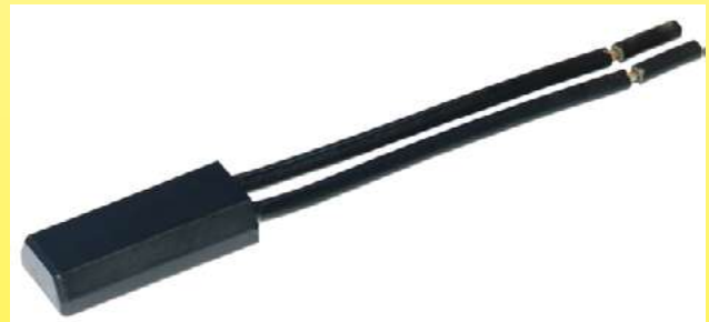
2019 Limiteur de température à rupture brusque pour couvertures chauffantes, dérivé du modèle Texas Instrument 7AM de 1966, utilisable en 230V, sous boîtier étanche plastique. Différentielle 5 à 8°C. Type V7AM. (Collection Ultimheat)
