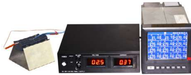
Equipement de mesure de la température de surface en fonction de la charge surfacique de la couverture ou du manteau chauffant
