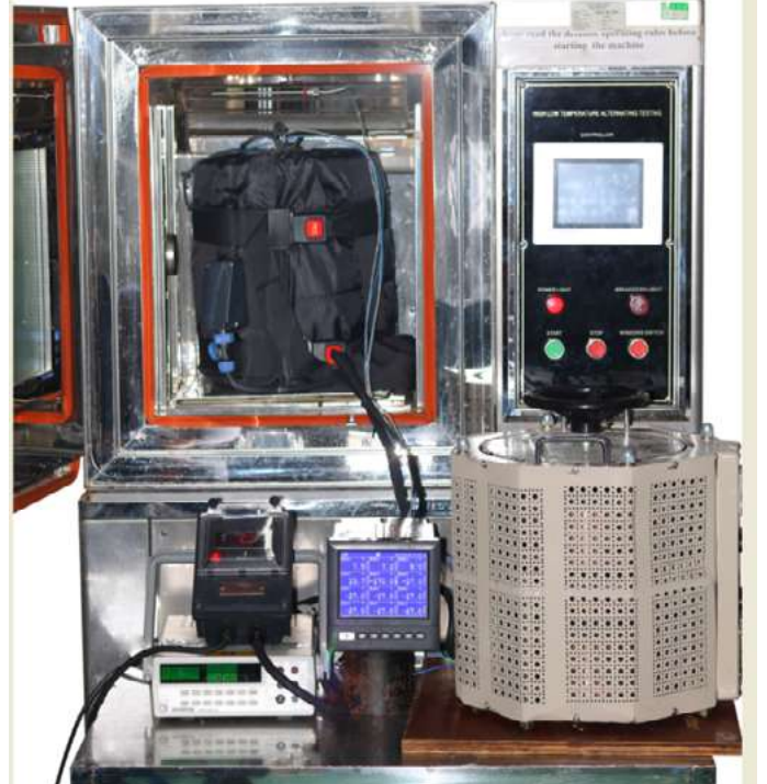
Couverture chauffante en cours d'essais climatiques en températures négatives
