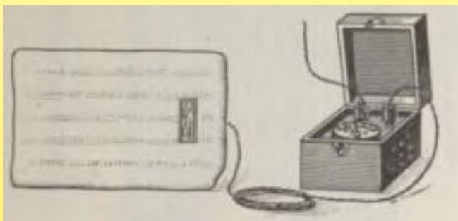
1903 Thermoplasme Parvillée. Dimensions 25cm x 35 cm Puissance : «inférieure à celle d'une lampe 5 bougies» soit environ 50 watts (à cette date). La charge surfacique était de l'ordre de 0.06W/cm 2 .
