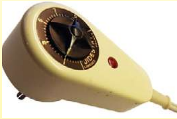
1972 ca Boîtier de réglage de la puissance réalisé par Jidé à Limoges sous la marque Jidéstat. Le plus abouti de tous les systèmes. De très faible dimensions, il est réglable, et incorporé dans la fiche électrique. C'est le seul modèle comportant un contact à rupture brusque par aimant. Il ne sera pas surpassé par les systèmes électromécaniques développés jusqu'à nos jours. (Collection Ultimheat)
