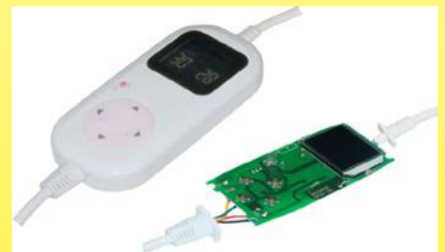
2019 Boîtier de commande de couvertures chauffantes à réglage de température à affichage digital par une sonde à thermistance incorporée dans la zone chauffante (Collection Ultimheat)
