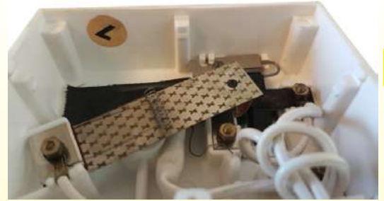
1970 ca réglage de puissance GEC (General Electric Company, Angleterre) sur couverture chauffante anglaise. La résistance anticipatrice est clairement visible au-dessus du bimétal et du contact à rupture lente (Collection Ultimheat).
