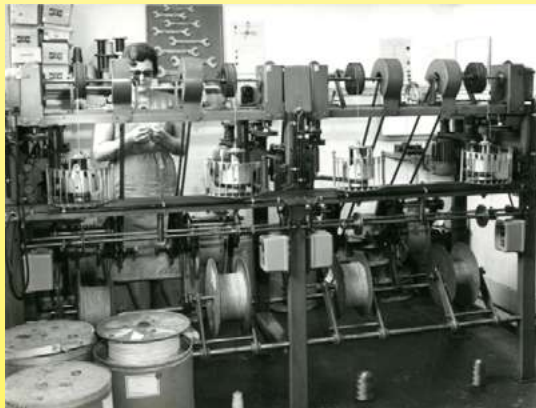
1960 ca. Atelier de guipage de cordes chauffantes pour couvertures électriques Vedette (Musée Ultimheat)
