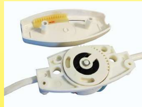
Interrupteur 3 positions chauffage et 2 positions arrêt sur couverture chauffante une place. Modèle intermédiaire entre les systèmes rotatifs et les systèmes à glissière (1970 ca marque de revendeur Gitem collection Ultimheat)
