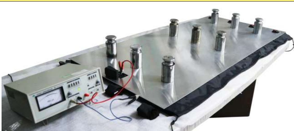
Dispositif de mesure de la résistance d'isolement. Les valeurs mesurées sont toujours supérieures à 0.1Gohm
