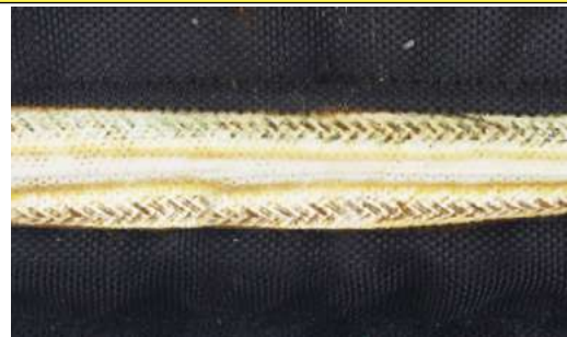
5 minutes à 245°C sur le câble chauffant, le PA66 a fondu, et laisse apparaître la couche de protection en PTFE qui n'est pas détériorée. La protection du cordon chauffant est toujours réalisée par l'isolation PTFE et silicone.
